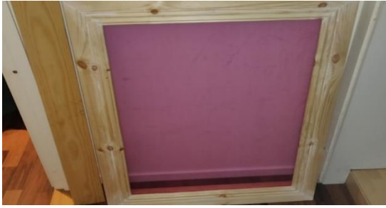
Figur 9 visar att plastfilmen sågades ut och passformen testades.
