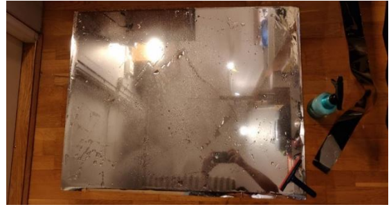
Figur 10. Spegelfilmen applicerades på plastglaset.
